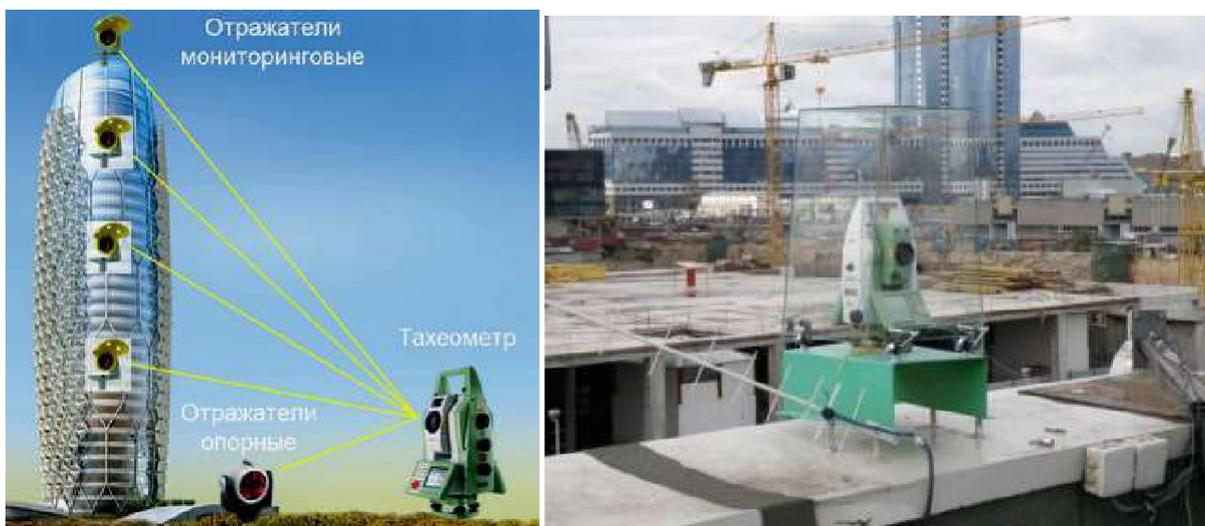
Рисунок 2.1 - Мониторинг здания с применением роботизированного тахеометра
